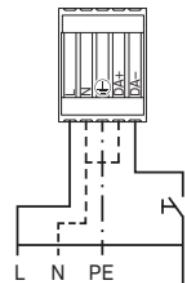
**DE** Anschlussschema für PhasenDim-Betrieb TRIAC
